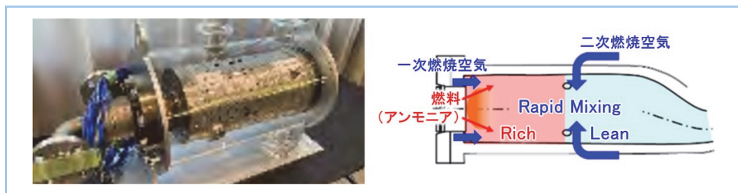
図 14 アンモニア燃焼器(リッチ・リーン二段燃焼方式)
