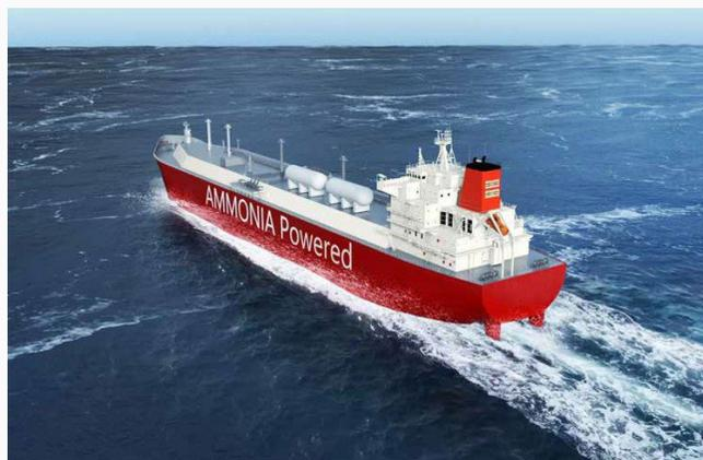
LPG燃料から、CO<sub>2</sub>を排出しないアンモニア燃料に転換可能なVLGC (大型ガス運搬船) のコンセプト設計を完了しました。
