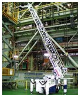
遠隔操作ロボットによるバルブ開閉作業
