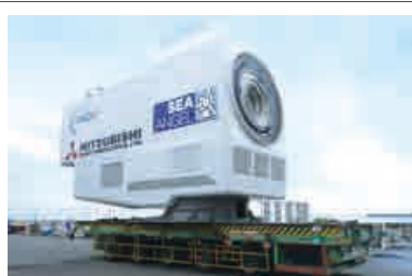
2013年1月から試験運転を開始した大型風力発電設備のナセル(発電機などを収納した部分)
