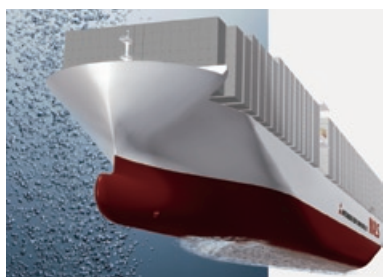
船体と海水の間に空気の層をつくることで、船体の摩擦抵抗を減少させる
