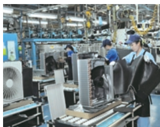
エアコン室外機の組立
