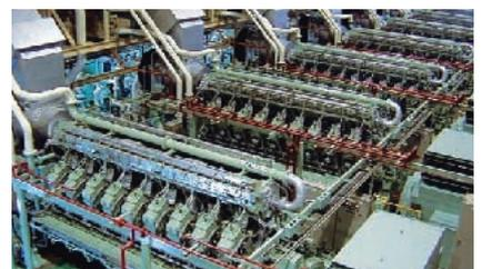
NOxやばいじんなどの排出が少ない利点を持つガスエンジン。コモンレールを採用したマイクロパイロット方式着火と、各シリンダーの個別最適制御とミラーサイクルの採用により世界最高レベルの発電効率45.5%以上を達成。
