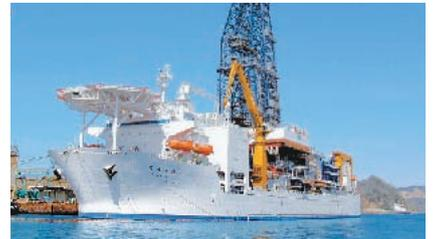
人類史上初めて地球内部マントルまでの掘削を目指すライザー掘削方式の科学調査船。水深2,500mの海域で海底下7,000mまでの連続した地質サンプル(コア)を採取することができ、地震や地殻にすむ微生物の研究に活躍している。
