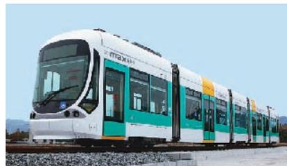
車両の床面を路面近くまで低くし、車内全体をフラットにした100%超低床車両。高齢者や身体障害者も円滑に乗り降りができ、快適な移動を実現した。同時に低騒音、低振動、低速から高速までの安定した走行性能も実現した。
