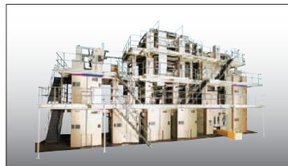
世界最高の印刷速度 (18万部/時) を誇る「DIAMOND STAR」。最新のニュースを、高精細なカラー印刷で提供。従来機に比べ約20%の損紙を削減するほか、20%の消費電力を低減するなどランニングコストの面でも優れている。
