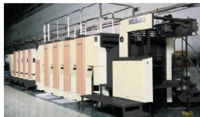
裏面印刷後に紙を反転させることなく、表面の印刷を可能にした世界に例のない印刷機。安定した両面高速印刷を実現し、ダブリや紙の伸び・ムダもシャットアウト。裏面印刷後の乾燥待ち時間を不要にして納期短縮に大きく貢献。
