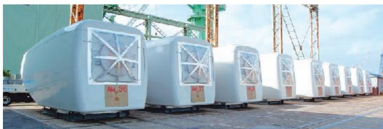
タワーの頭頂部で回転軸、発電機などを格納するナセル
