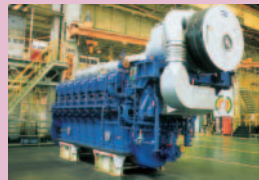
●発電用ガスエンジン
