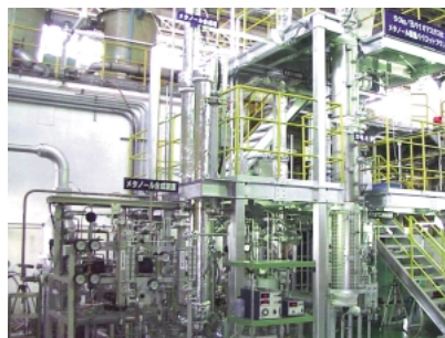
バイオマスガス化 メタノール製造 パイロットプラント
