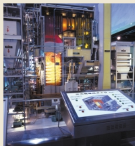
火力発電用ボイラ
