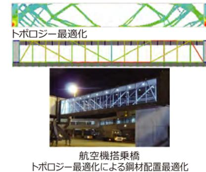
航空機搭乗橋 トポロジー最適化による鋼材配置最適化
