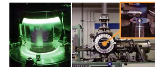
超高温摩擦摩耗試験装置
