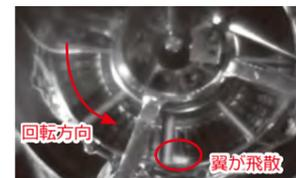
高速回転試験 破壊の瞬間の状況
