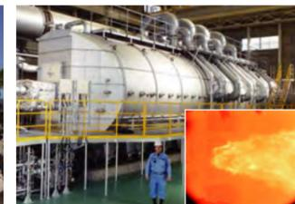
ボイラ燃焼試験設備
