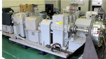
大容量モータ・発電機評価設備
