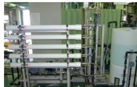
逆浸透膜モジュール試験装置
