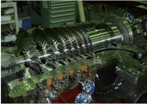
軸流コンプレッサ試験設備
