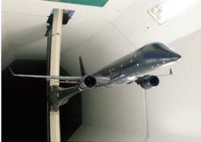
低速風洞試験設備
