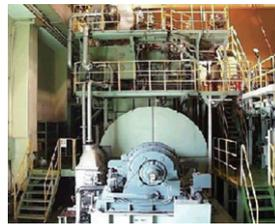
大型単気筒試験設備
