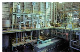
高温高圧ループ腐食試験装置
