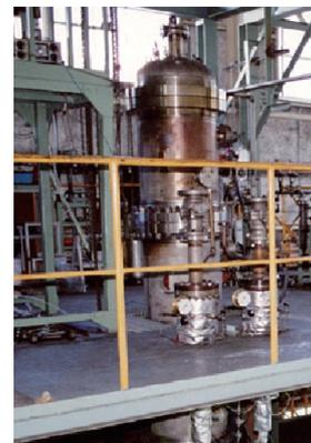
流動床反応試験装置
