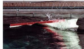
水槽試験による波浪中の安全性評価
