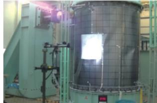
原子力格納容器モデル座屈試験
