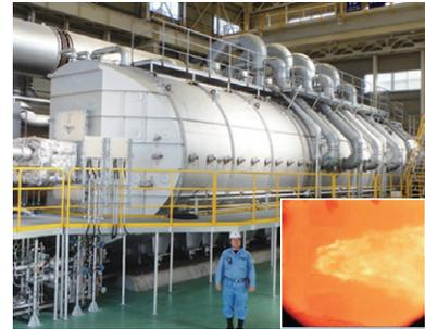
ボイラ燃焼試験設備
