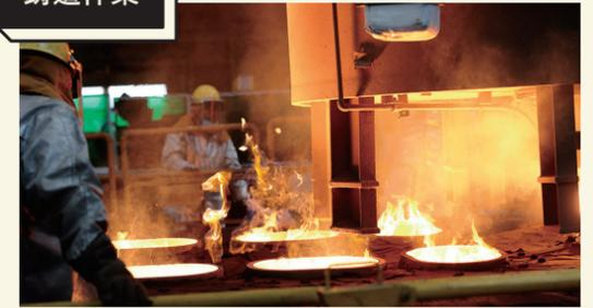
でき上がった溶湯を鑄型に流し込みます。鑄造作業も
