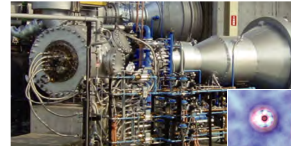
フルスケール 高圧燃焼可視化試験装置
