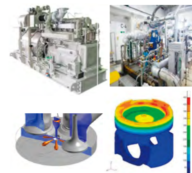
水素エンジンと燃焼解析による筒内評価事例
