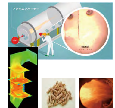
ボイラ燃焼解析とアンモニア/バイオマス専焼状況
