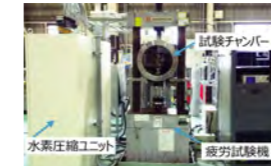
水素関連製品の信頼性を検証するための水素環境中試験装置
