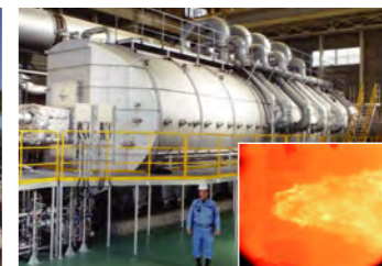
ボイラ燃焼試験設備
