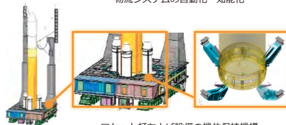
ロケット打ち上げ設備の機体保持機構
