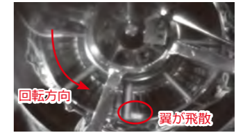
高速回転試験 破壊の瞬間の状況
