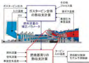
急速な負荷変化を実現するガスタービン向けモデル予測制御技術
