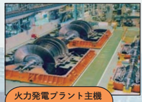
火力発電プラント主機 (蒸気タービン)
