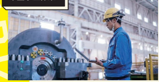
車室の健全性を確認するため耐圧チェックを行います。
