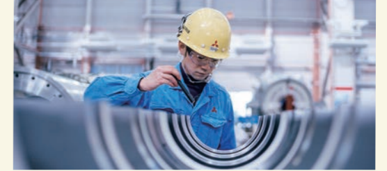
工場内で試運転を行い、機器の健全性を確認し、S/RからW/Rへの入替え作業を行います。
