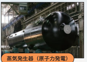
蒸気発生器 (原子力発電)
