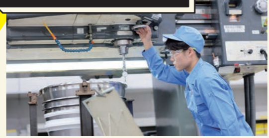
航空機部品の定期修理における部品の修正加工（オーバーホール）を行います。
