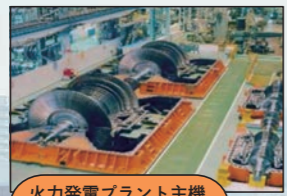
火力発電プラント主機 (蒸気タービン)
