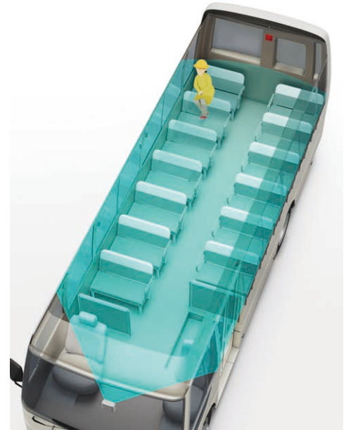
車内をレーダーセンサーでセンシング
