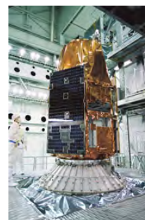
2012年5月1日 「アリアン3号」と衛星分離部を衛星搭載アダプタに結合
