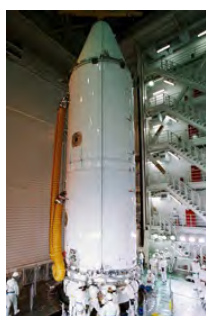
2012年5月8日 衛星4基を収納した衛星フェアリング、H-IIAロケット21号機の第2段に搭載。(その2)
