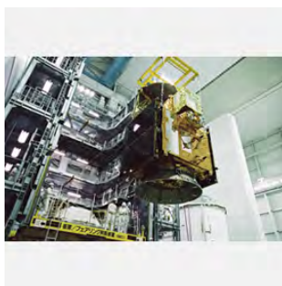
2012年4月26日 「しずく」と衛星分離部を衛星搭載アダプタに結合
