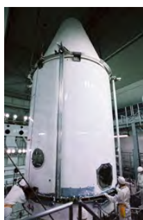
2012年5月3日 「アリアン3号」と衛星分離部を上部衛星フェアリングへ収納
