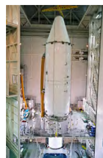
2012年5月8日 衛星4基を収納した衛星フェアリング、H-IIAロケット21号機の第2段に搭載。(その1)
