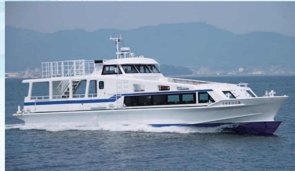
観光船 S6B3-T2MTK2L 435kW/2001rpm
