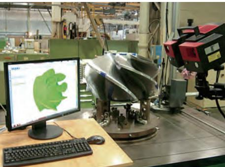
翼面全面の3D計測管理による高い信頼性
