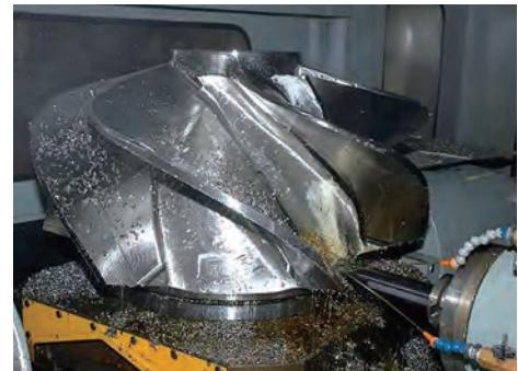
翼面全面NC削り出しによる高精度製造
