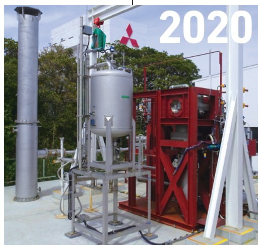
液体窒素試験にて90MPa昇圧達成
