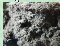
脱水汚泥 (水分70%以下)
