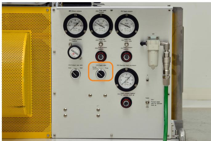
保護ガス (ドライエア) の供給が止まり、ASCENT に接続されていたシリンダがステーションに収納されます。PURGING ランプが点灯します。
