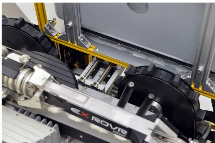
掃気中に ASCENT の電源を入れることができないように、ステーションの電源ガードが下降して ASCENT の電源投入部を隠します。
