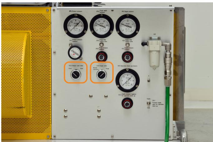
**6** 制御盤のモードスイッチを「PURGE」にする。
