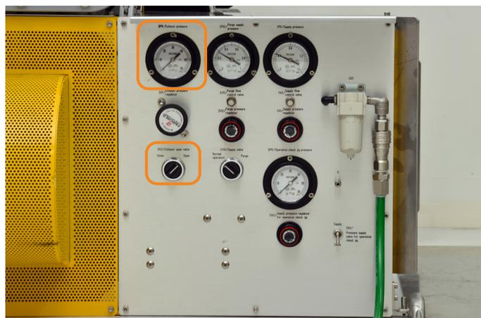
**5** ステーションの空配盤の「3V2/Exhaust open valve (排気系統開放弁)」を「Close (閉止)」にし、「2V4/Supply valve (供給圧切換弁)」を「Purge (掃気)」にする。
