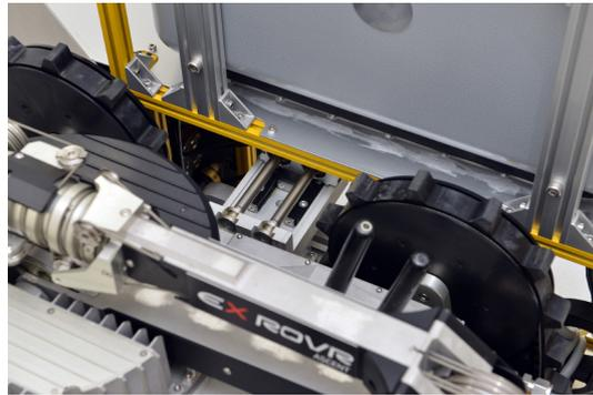
シリンダに連動する電源ガードの動作も一緒に確認します。
