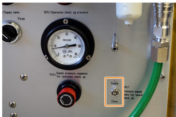
インターロック確認治具治具のエア噴出口からエアが出て、5P11/Operation check jig pressure (差圧センサ動作確認圧力) が下がります。
