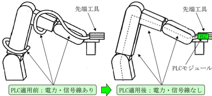
図1：PLC適用による省配線化
