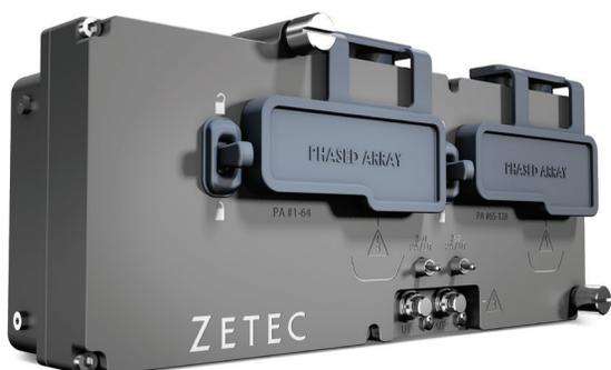
**プローブスプリッター：**例えば、溶接線に対してフェーズドアレイプローブを対抗配置するようなアプリケーションで2つのプローブを同時接続する必要がある場合に用います。プローブスプリッターは2つの異なる種類のコネクタをラインナップしています：ZPACコネクタ（ZETEC純正コネクタ）及びOmniタイプコネクタ
