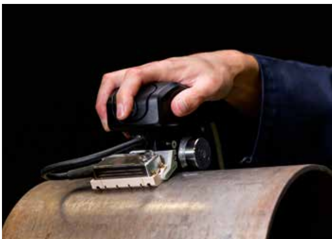
図 1: PaintBrush2は曲面や直径100mmのパイプの検査が可能
