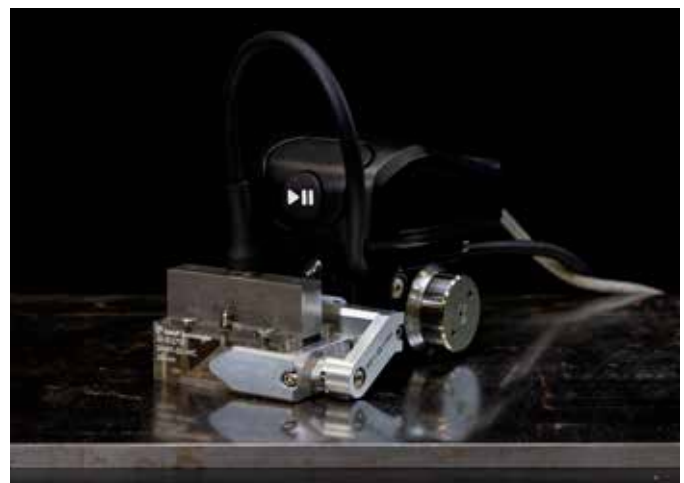
図 3: 複合材料検査用NW1プローブを装着したPaintBrush2
