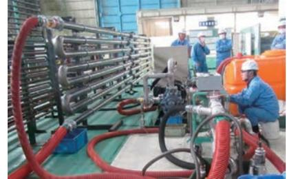
▲ボイラチューブ減肉検査インナー UT (超音波水浸法による内挿式管厚測定システム) 準備が要で、チューブ全周・全長計測が可能です。
