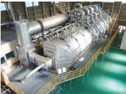
◀三菱重工総合研究所の燃焼試験設備では、低NOx、低未燃分、低空気過剰率など、ボイラ性能の根幹をなす燃焼技術の高度化研究を行っています。
