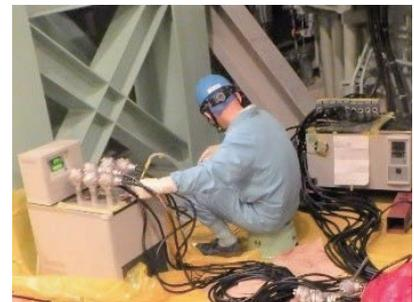
▲某原子力発電所定期検査での計測用温度センサの動作確認。
