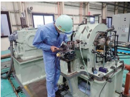
◀三菱重工総合研究所のシール材摩耗試験。現象を手と目で感じます。
