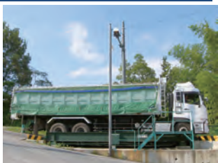
積載車両入庫時、停車して約 20 秒計測
