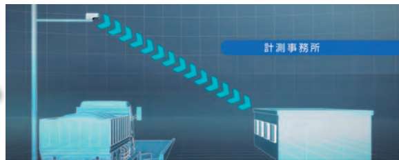
容量計測PCにより（積荷－空荷）容量計算を行います。 積載容量表示、帳票印刷もすぐにできます。
