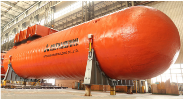
LNG燃料タンク
