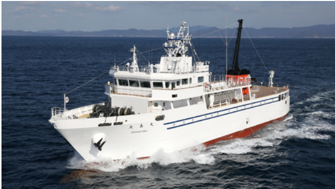
練習船 大島丸 総トン数 ..... 373 トン 速力 ..... 12.5 knots 全長 ..... 56.49 m 建造場所 ..... 下関 幅 ..... 10.60 m
