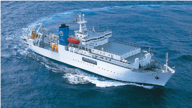
ケーブル敷設船 すばる 総トン数 ..... 9,557 トン 速力 ..... 13.2 knots 全長 ..... 123.33 m 建造場所 ..... 下関 幅 ..... 21.0 m
