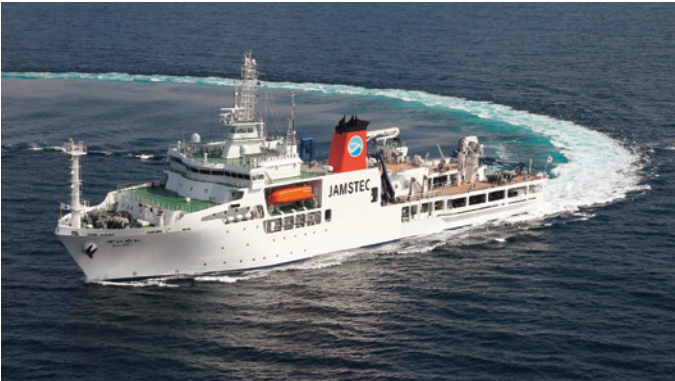
海底広域研究船 かいめい 総トン数 ..... 5,747 トン 速力 ..... 12 knots 全長 ..... 100.5 m 建造場所 ..... 下関 幅 ..... 20.5 m
