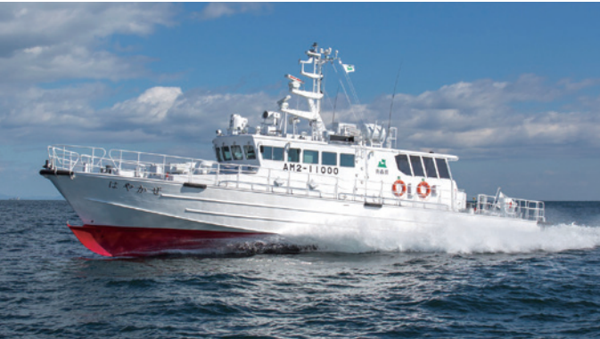
漁業取締船 はやかぜ 総トン数 ..... 56 トン 速力 ..... 35 knots 以上 全長 ..... 26.0 m 建造場所 ..... 下関 幅 ..... 5.4 m
