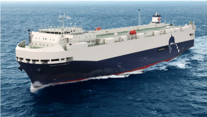
自動車運搬船 TRANS FUTURE 11 総トン数 ..... 28,775 トン 速力 ..... 21.0 knots 全長 ..... 165.0 m 建造場所 ..... 下関 幅 ..... 27.6 m
