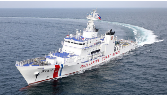
多目的対応船 TERESA MAGBANUA 総トン数 ..... 2,265 トン 速力 ..... 24knots 全長 ..... 96.6 m 建造場所 ..... 下関 幅 ..... 11.5 m
