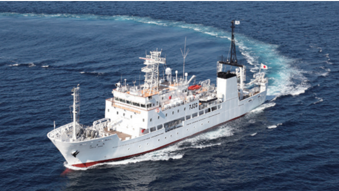
漁業練習船 天鷹丸 総トン数 ..... 995 トン 速力 ..... 12 knots 全長 ..... 64.67 m 建造場所 ..... 下関 幅 ..... 11.90 m
