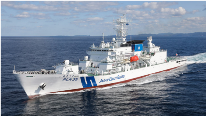
ヘリコプター搭載型 (6,500トン型) 巡視船 あさづき 総トン数 ..... 6,500 トン 速力 ..... 25.5knots以上 全長 ..... 150 m 建造場所 ..... 下関 幅 ..... 16.8 m
