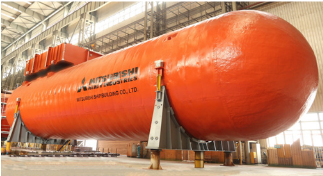
LNG燃料タンク
