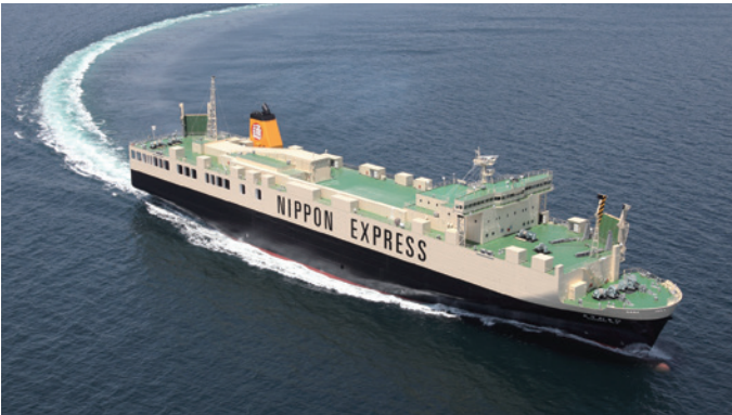
RORO船 ひまわり8 総トン数 ..... 10,626 トン 速力 ..... 23.0 knots 全長 ..... 166.9 m 建造場所 ..... 下関 幅 ..... 27.0 m
