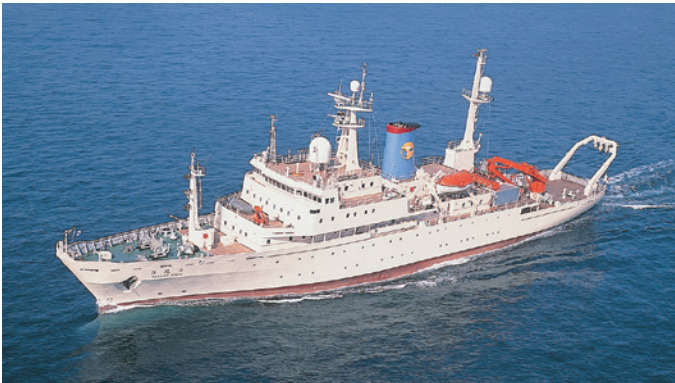
学術研究船 白鳳丸 総トン数 ..... 3,991 トン 速力 ..... 16 knots 全長 ..... 100.0 m 建造場所 ..... 下関 幅 ..... 16.2 m
