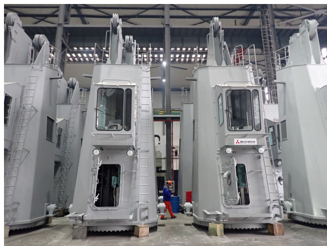
保管エリアで出荷を待つデッキクレーン
