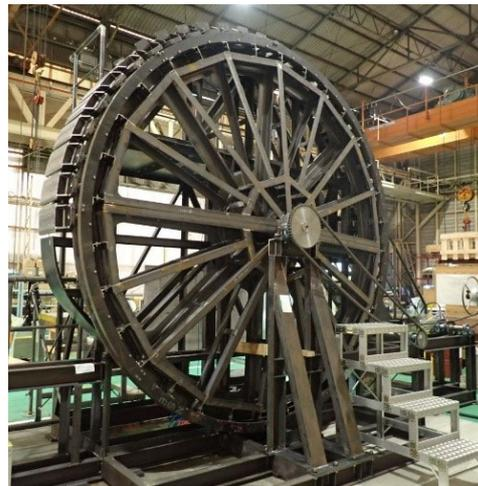
新型ケーブルエンジン模擬試験装置
