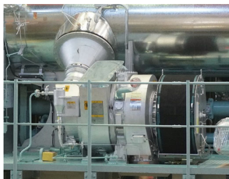
匹配了三井E&S Machinery制造的发动机的MET增压器
