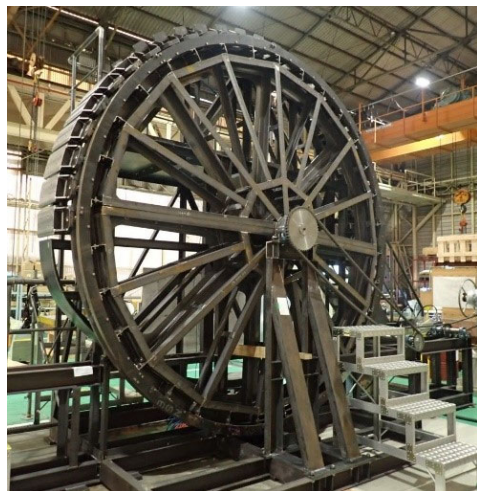
新型电缆敷设机模拟试验装置
