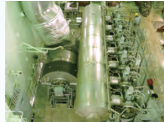
ハイブリッド過給機(MET83MAG)搭載エンジン
