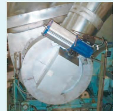
開閉弁を装着したVTI過給機
