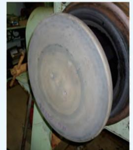
耐熱鋼を溶接肉盛した新型弁
