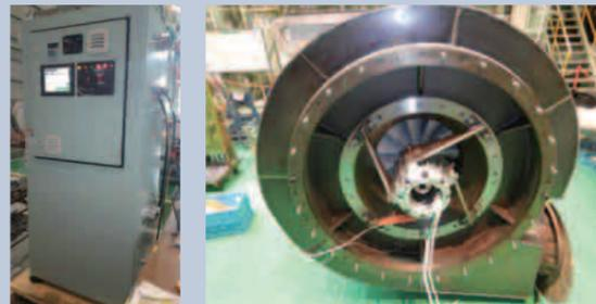
MET83SE過給機に取り付けた駆動軸と巻線
