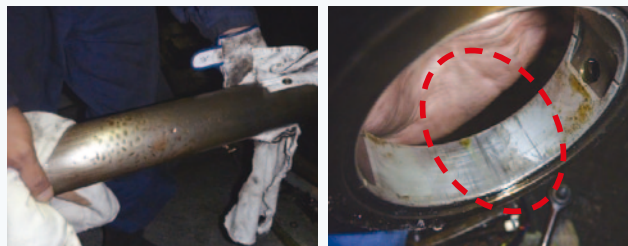
ロータガイド管の腐食及び表面の疵により、ロータ引抜時にジャーナル軸受が損傷した事例
