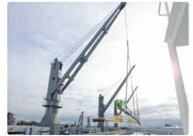
3台シンクロ制御クレーン（150t）
