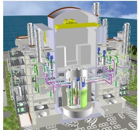
ナトリウム冷却タンク型高速炉
