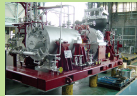
E GTL プラント用循環ガス圧縮機及び蒸気タービン
