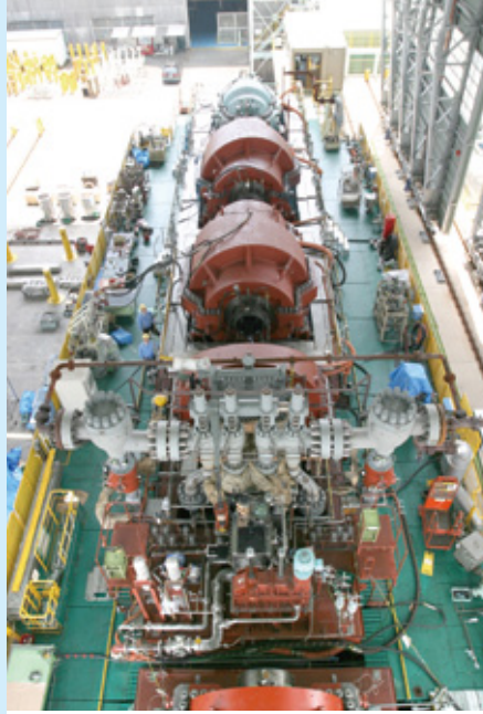
G エチレンプラント用分解ガス圧縮機及び駆動蒸気タービン
