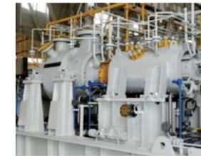
Компрессор закачки газа на плавучей системе нефтедобычи
