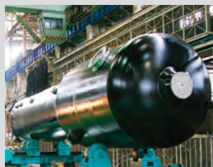
取替用蒸気発生器
