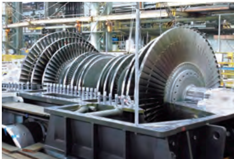
地熱発電用蒸気タービン
