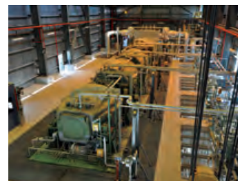
(上) 大形工作機械/門形五面加工機 (下) エチレンプラント用分解ガスコンプレッサ・ 蒸気タービン
