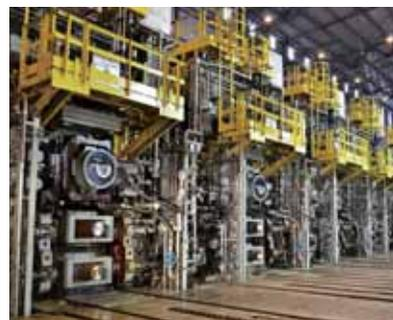
製鉄機械（熱間圧延設備）
